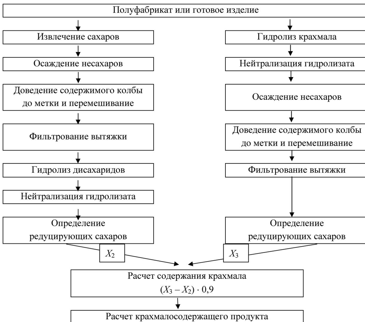
Рис. 2. Схема определения крахмалосодержащих продуктов
